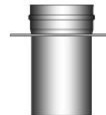
Einbau Dehnelement unterhalb des 2. T- Stücks
