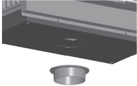
Abb. 2.7 Montage des Verbrennungsluftstutzens unter dem Geräteboden
