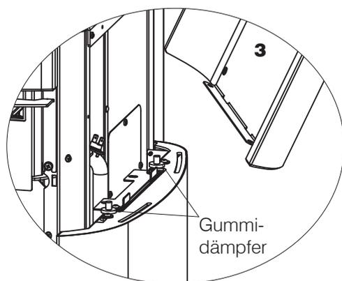
Eventuelle Regulierungen der Ausrichtung zwischen Keramik-/Natursteinblende und Tür können über die oberen oder unteren Schrauben der am Grundkörper befestigten Halterung ausgeführt werden.
