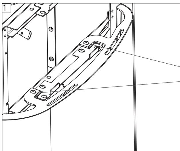
Schrauben zur Abnahme der Seitenteile
