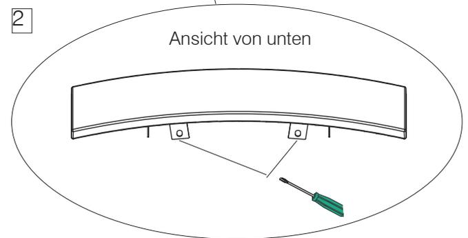
3. Die obere Frontblende -2- (Keramik oder Naturstein) auf die Metallhalterung (S) legen. Die Frontblende (2) mit den zuvor gelösten Schrauben anschrauben.
