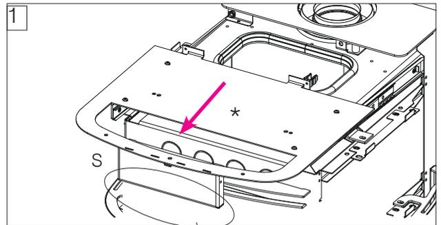
2. Die beiden unteren Schrauben lösen, die anschließend zur Befestigung der Frontblende dienen
