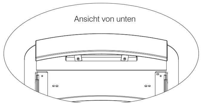
Die Feuerraumtür schließen und die Ausrichtungen kontrollieren.
