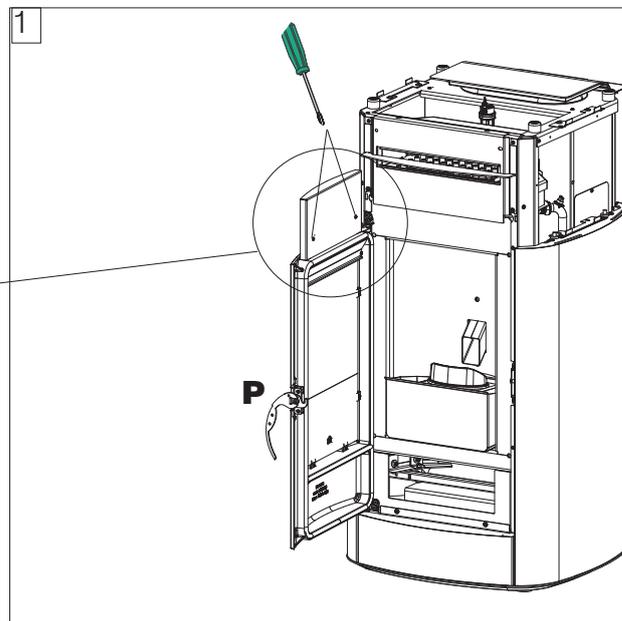
2. Die Schrauben lösen (B). Die Frontblende (1) aus Keramik oder Naturstein auf der Metallhalterung über der Tür einsetzen.
