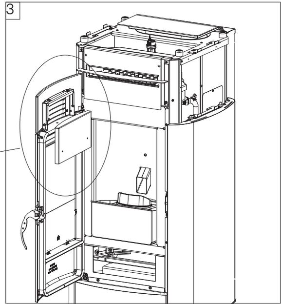
4. Mit den beiden unter Punkt 1 entfernten Schrauben befestigen
