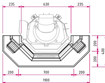
**Hinweis Seitenansicht M 1:25:** AS: Abgasstutzen, VLS: Verbrennungsluftstutzen, OKFF: Oberkante Fertigfußboden
