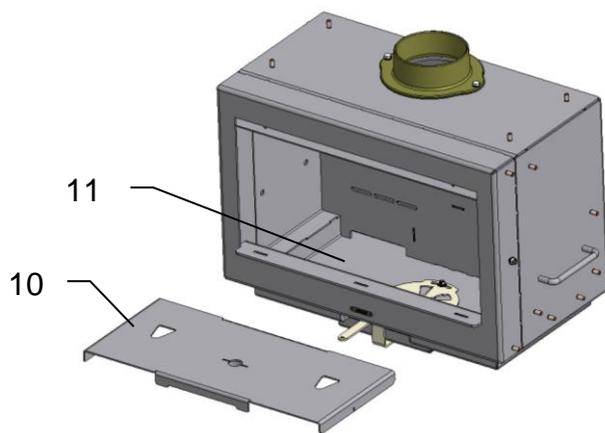
Zum Reinigen der Brennkammer die Brennräumeauskleidung komplett ausbauen. Den Revisionsdeckel (10) entnehmen. Den Brennraumboden und die Luftkanäle (11) mit einem geeigneten Staubsauger säubern.
