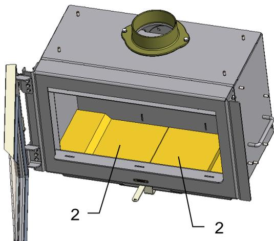
Die beiden Bodenplatten (2) in den Brennraum einlegen, zu den Seitenwänden ausmitteln und nach vorne schieben.
