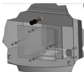
VI Abschließend wird das **Abdeckblech** auf der Vorderseite der Zuluftseinheit wieder montiert.
