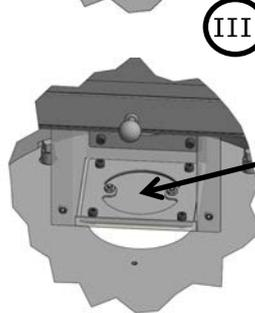
III Jetzt muss die im Boden der Zuluftseinheit eingeschraubte **Adapterplatte** abgeschraubt werden (4 Zylinderkopf-Schrauben SW 4 mm).
