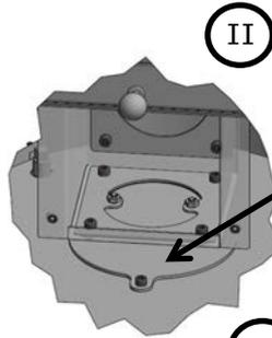
II Dann muss die im Boden des Volare eingeschraubte **Abdeckplatte** abgeschraubt werden (4 Zylinderkopf-Schrauben SW 4 mm).
