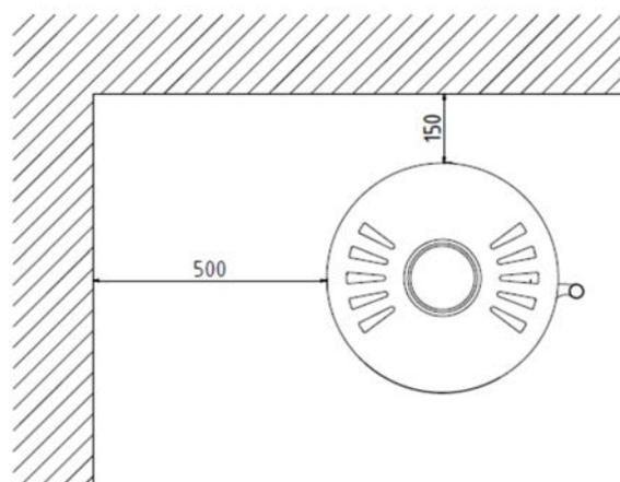
Der Sicherheitsabstand muss zu brennbaren Bauteilen und Möbeln nach hinten mindestens 15 cm und zu den Seiten mindestens 50 cm betragen. Im Strahlungsbereich der Glasscheibe dürfen im Abstand von 90 cm keine brennbaren Bauteile oder Möbel aufgestellt werden. Wenn der VOLARE mit einem Drehteller ausgestattet ist, darf der Ofen im heißen Zustand nicht in Richtung brennbarer Bauteile oder Möbel gedreht werden, wenn der Abstand zu diesen nicht mindestens 90 cm beträgt.
