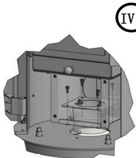
IV Diese **Adapter-**platte wird mit dem **Zuluftstutzen** verschraubt (2 x Zyl.-Kopf-Schraube SW 4 mm), durch die Öffnung im Boden der Zuluftseinheit gesteckt und hier wieder (wie vorher) mit den 4 Schrauben incl. Unterlegscheiben montiert.
