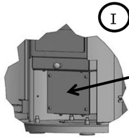
I Um den Zuluftstutzen unten zu montieren, muss zuerst das **Abdeckblech** der Zuluftseinheit abgenommen werden. Dieses finden Sie – wenn die untere Bedientür geöffnet wird – unterhalb des Luftregulierhebels
