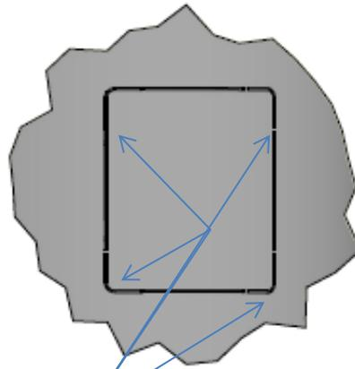
Diese Stege müssen durchgetrennt und das Blech entfernt werden, damit ein Zuluftkanal von hinten an den Zuluftstutzen montiert werden kann.
