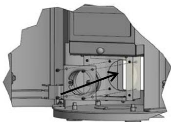
Abweichend von der Montage nach unten wird nun das Abdeckblech an der Rückseite der Zuluftseinheit abgeschraubt und im Boden, wo vorher die Adapterplatte war, angeschraubt (Adapterplatte und Abdeckblech der Rückseite werden somit gegeneinander getauscht).
