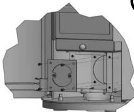
V Jetzt noch das **Verschlussblech** an der Rückseite der Zuluftseinheit anschrauben.
