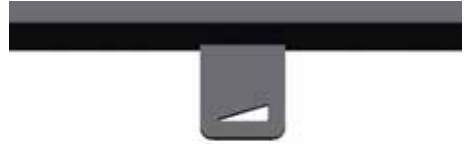
Abb. 3.7 Verbrennungslufschieber halb rechts bis mittig
