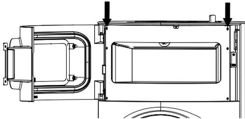
Abb. 37: Backfach Tür öffnen und Schrauben lösen
