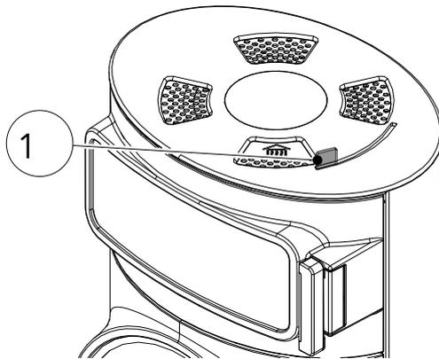
Abb. 36: Konvektionsluftregler
