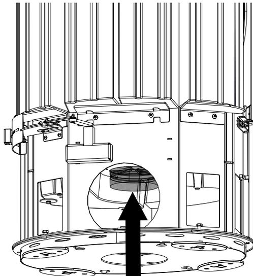
Abb. 18: Aluflexschlauch befestigen
