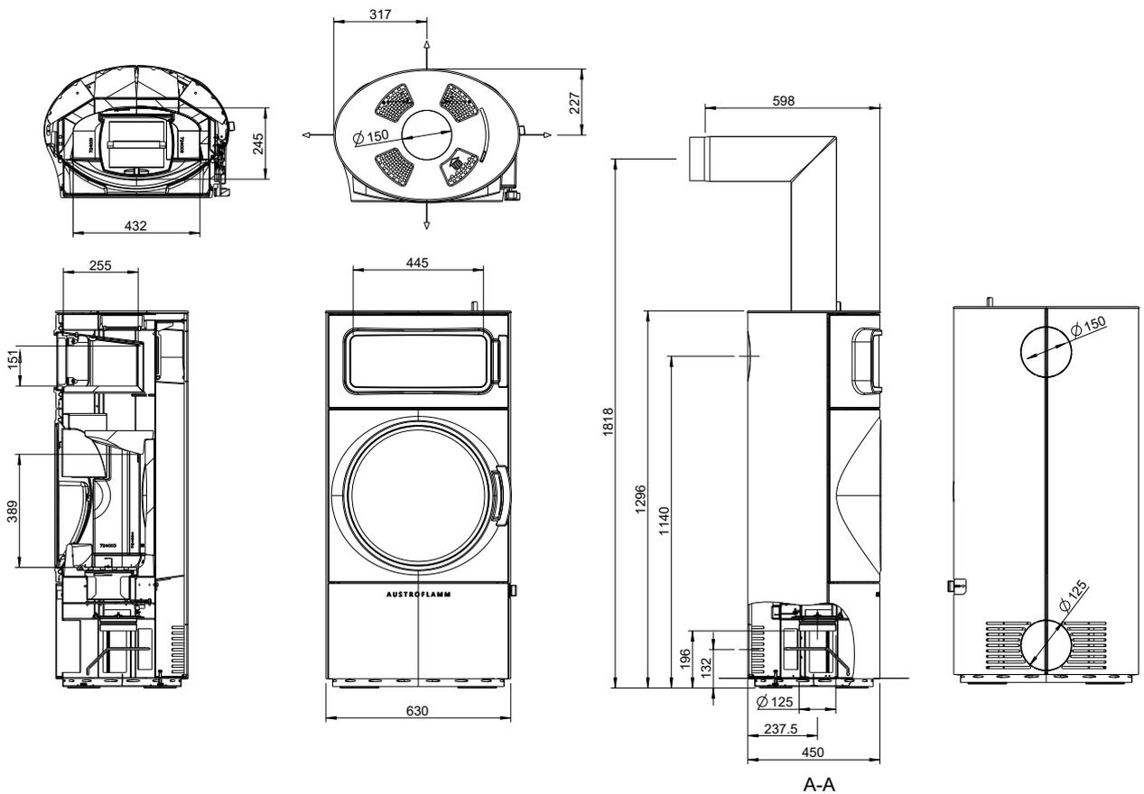
Abb. 2: Abmessungen Grundgerät
