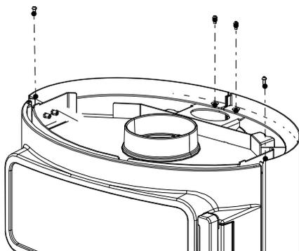
Abb. 39: Schrauben lösen
