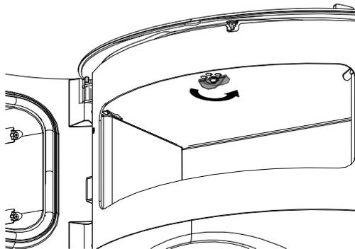
Abb. 28: Luftregler Backfach
