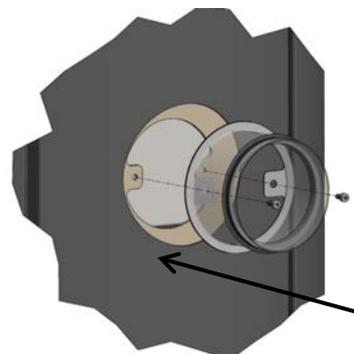
Den Stutzen nun mit 2 Schrauben an den hier sichtbaren „Laschen“ befestigen. Hieran kann jetzt die Zuluftleitung angeschlossen werden.
