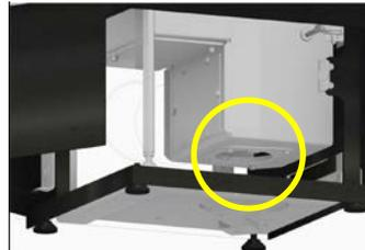
Dann wird dieses Adapterblech abgeschraubt und mit dem Zuluftstutzen verschraubt. Anschließend den Zuluftstutzen mit dem angeschraubten Adapterblech wieder anschrauben. Dann das vordere Blech wieder montieren.
