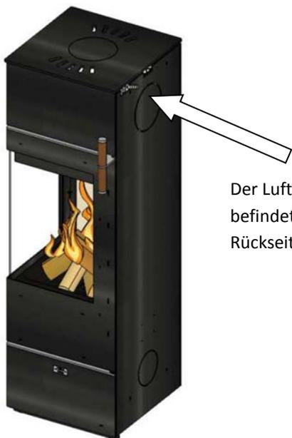
Der Luftregulierhebel befindet sich hier an der Rückseite des Ofens.
