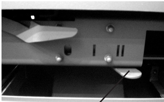
Levier de commande pour l'alimentation en air de combustion
