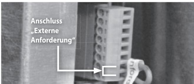
Dieser **potenzialfreie Schalteingang** erteilt eine Freigabe oder blockiert das Gerät. Bei einer Blockierung wird das Gerät komplett deaktiviert.
