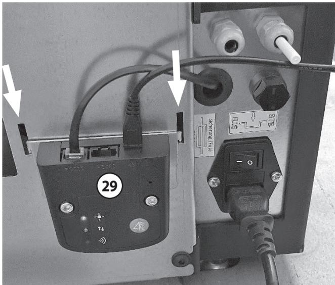
► Schieben Sie das Anschlusskabel so weit wie möglich zurück in das Gerät.
