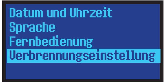
Für die optimale Anpassung des Gerätes an den zum Anschluss vorgesehenen Schornstein kann hier die Verbrennung in 4 Stufen eingestellt und die Einstellung gespeichert werden.
