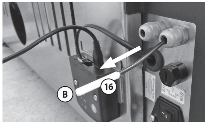
**i** Der **Raumtemperaturfühler (16)** ist im hinteren Bereich des Gerätes in Bodennähe platziert, der normalerweise kühleren Stelle des Gerätes.
