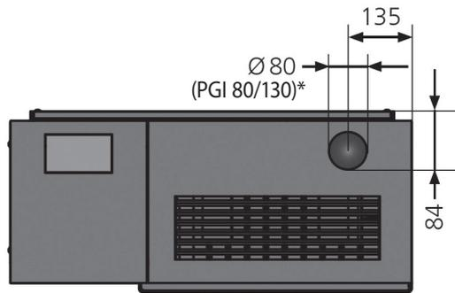
\* Sondervariante Rauchrohranschluss oben für „System Poujoulat PGI 80/130 mm“
