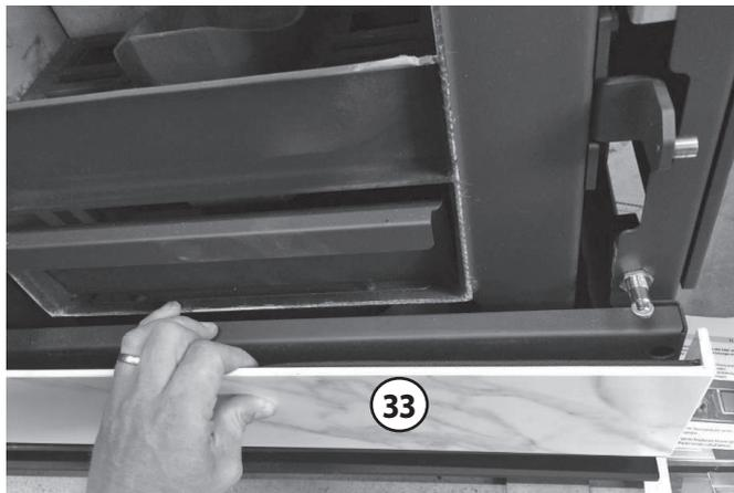
Nach Abnehmen der **unteren Frontverkleidung (33)** wird ein Blendenblech zugänglich. Dieses Blendenblech ist mit 2 Inbusschrauben (Schlüsselweite 3 mm) befestigt.
