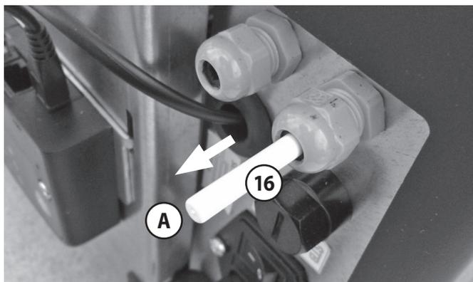
Es kann unter Umständen auch notwendig sein, dass der **Raumtemperaturfühler (16)** noch weiter aus dem Gerät herausgezogen werden muss (**B**).
