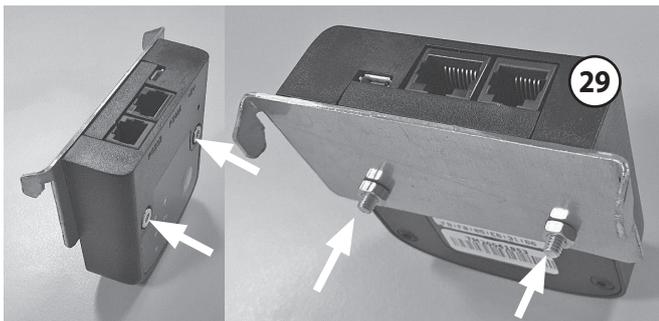
Schließen Sie das **Wi-Fi-Modul (29)** an das Gerät an. Das Anschlusskabel befindet sich in einer Kabeldurchführung an der Rückseite des Geräts in der Nähe des **Netzschalters (19)**.
