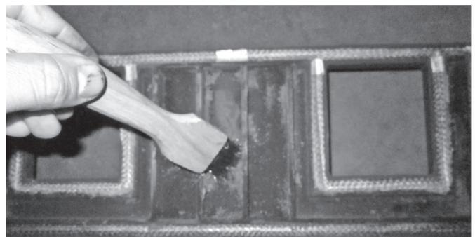
Bei abgenommenen Brennraumdeckel werden die Heizgaszüge sichtbar und zugänglich.
