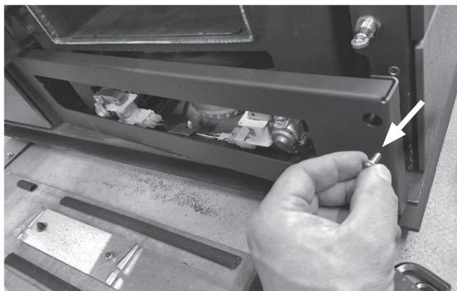
Nach der Demontage der Verkleidung und des Blendenblechs kann der **Gebläsedeckel** unterhalb des **Aschenkastens (6)** abgenommen werden:
