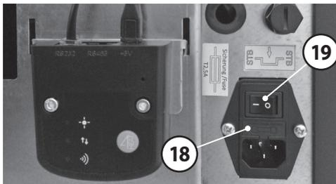
Im Bereich des **Netzschalters (19)** befindet sich auch die **Geräte-Hauptsicherung (18)**.
