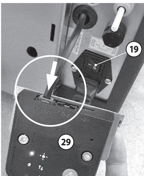
Schließen Sie die Stromversorgung an das **Wi-Fi-Modul (29)** an.
