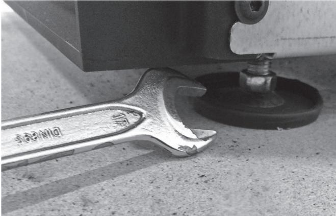
**i** Das Gerät erzeugt mit Gebläse und Förderschnecke im Betrieb nur leise Geräusche, die sich aber unter ungünstigen Umständen, abhängig von der Beschaffenheit der Aufstellfläche, über die **höhenverstellbaren Gerätefüße (8)** auf die Aufstellfläche übertragen können (Körperschall). Um diese Schallübertragung zu vermindern, empfehlen wir in diesen Fällen den Einsatz von schall- und schwingungsdämpfenden Platten zwischen den **höhenverstellbaren Gerätefüßen (8)** und der Aufstellfläche.
