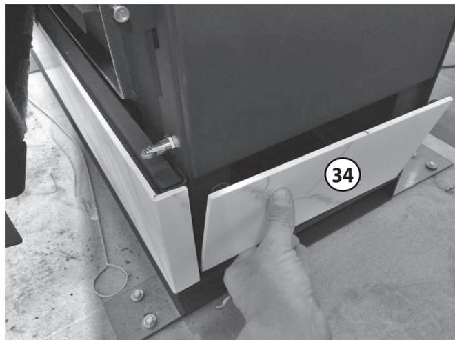
Im Gerätekörper wird nun der Rauchrohrbogen mit Reinigungsklappe zugänglich.
