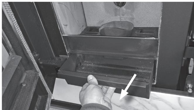
Der **Aschenkasten (6)** ist mindestens jeden zweiten Betriebstag zu kontrollieren und ggf. zu entleeren!
