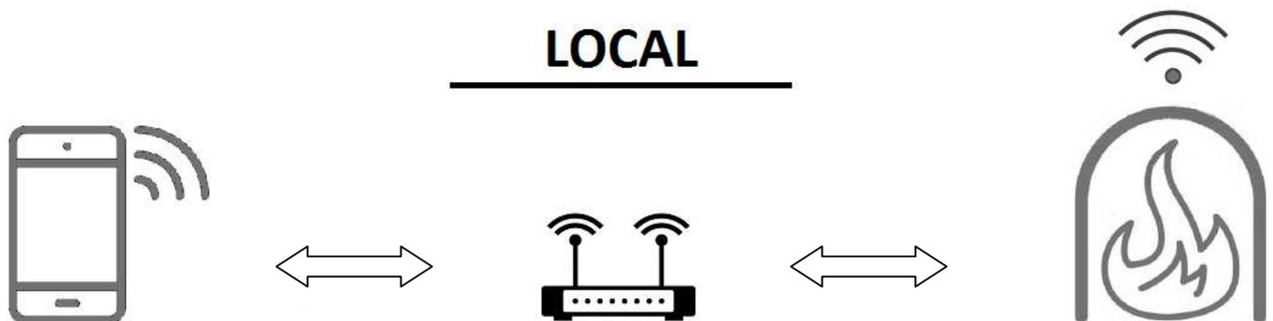
Im Verbindungsmodus LOCAL verbindet sich die App über das WiFi-Netz Ihres Routers im Aufstellungsraum mit dem Ofen, Heizkessel oder Kamineinsatz. Dieser Modus ermöglicht eine lokale Überwachung des Ofens, ohne die Konnektivität des Smartphones oder Tablets zu unterbrechen. (Der Gebrauch der App ist im zugehörigen Benutzerhandbuch beschrieben.)
