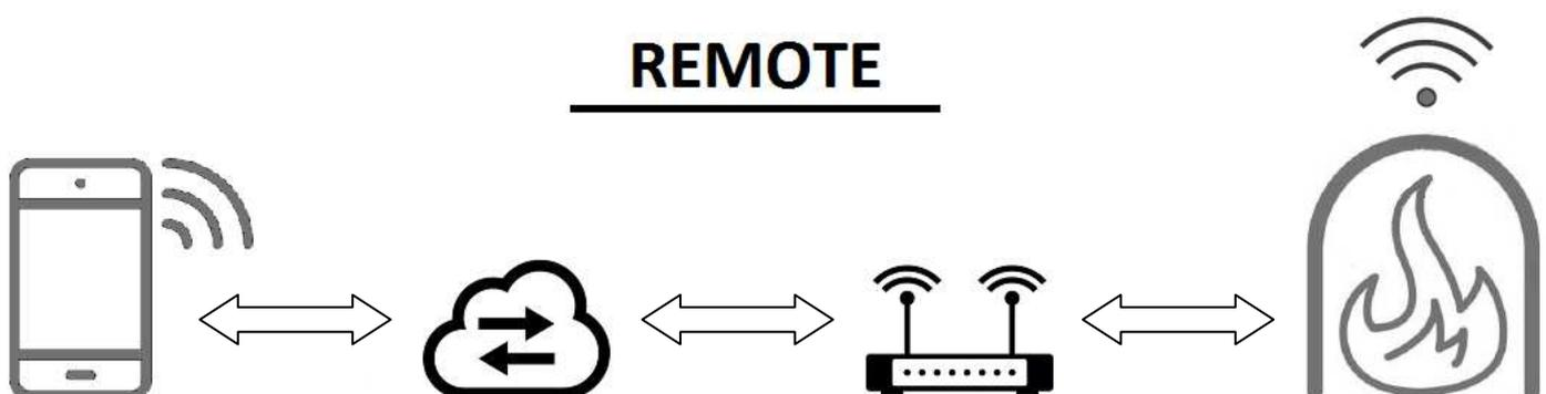
Im Modus REMOTE (CONNECTED) verbindet sich die App über die Internetverbindung des mobilen Geräts mit dem Webserver (Cloud). Dieser interagiert mit dem WiFi-Router im Aufstellungsbereich und sorgt für einen Zugriff auf den Ofen, Heizkessel oder Kamineinsatz, der mit dem WiFi-Netz verknüpft ist. (Der Gebrauch der App ist im zugehörigen Benutzerhandbuch beschrieben.)
