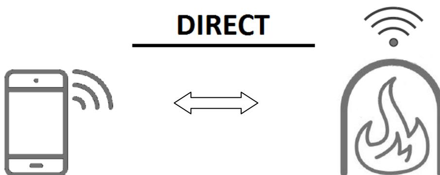
Im Verbindungsmodus DIRECT verbindet sich die App über das WiFi-Signal des Modems, das an den Ofen, Heizkessel oder Kamineinsatz angeschlossen ist, direkt mit dem Modem. (Der Gebrauch der App ist im zugehörigen Benutzerhandbuch beschrieben.)
