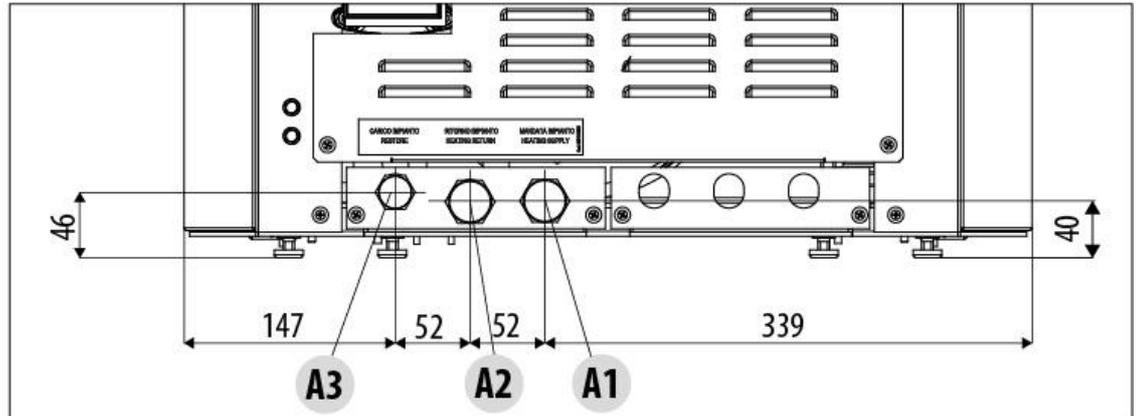
A1 = Wasservorlauf Heizung 3/4" M
