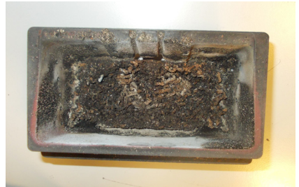
BEISPIEL VERSCHMUTZTE BRENNSCHALE
