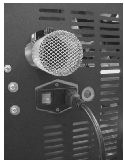
Elektrischer Anschluss des Heizofens
