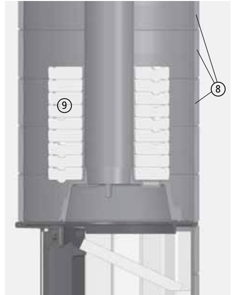
Abb. 3.39 Aufsatz mit 6 Gussringen und 9 Guss-Speichereinlagen
