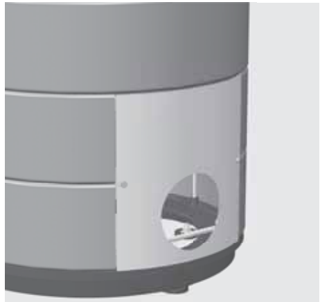
Abb. 3.20 Revisionsblech an der Geräterückseite mit Ausschnitt für die Leitung
