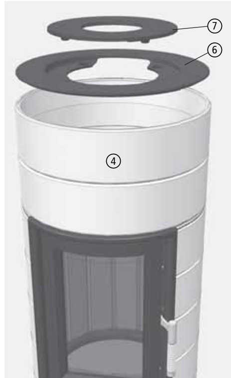
Abb. 3.38 Aufbau des Aufsatzes
