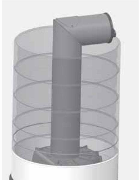
Abb. 3.42 im Aufsatz eingesetztes Heizgasrohr mit Anschlussflansch
