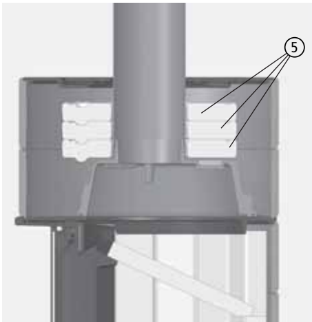
Abb. 3.37 Aufsatz mit 2 Gussringen und 3 Guss-Speichereinlagen
