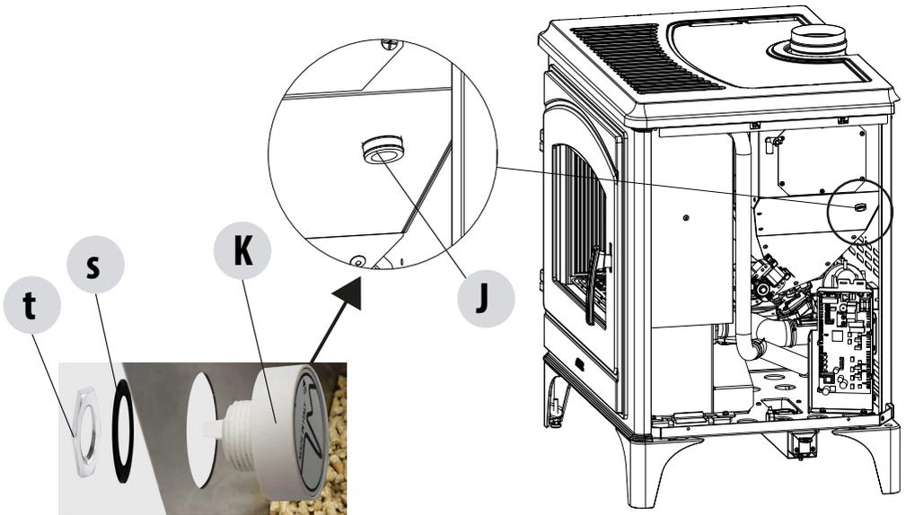
Der Pellet-Sensor ist ein Anzeiger für die Brennstoffreserve, der dazu dient, dem Benutzer zu melden, dass die Pellets fast verbraucht sind. Wenn der Behälter leer ist, den Deckel zum Einfüllen der Pellet anheben, den im Innenbereich bereits montierten Verschluss „J“ mit der Hand entfernen und den Sensor „K“ für Pellet-Füllstand immer vom Inneren des Behälters aus einsetzen.
