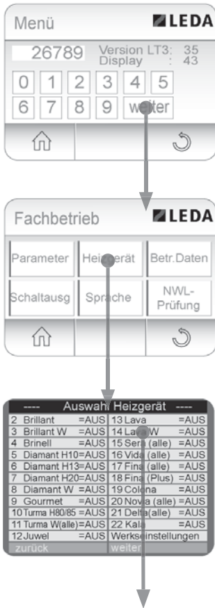
Abb. 4.13 Zugriff auf die Heizgeräte-Ebene
