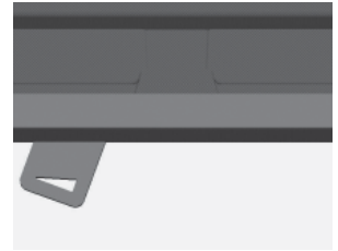
Abb. 6.5 Verbrennungsluftschieber: ganz links - ganz geschlossen
