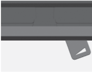
Abb. 6.3 Verbrennungsluftschieber: ganz rechts - Luft ganz geöffnet
