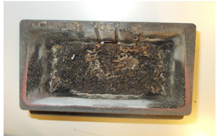
BEISPIEL VERSCHMUTZTE BRENNSCHALE
