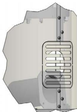
Diese Stege müssen durchgetrennt und das Blech entfernt werden, damit ein Zuluftkanal von hinten an den Zuluftstutzen montiert werden kann.
