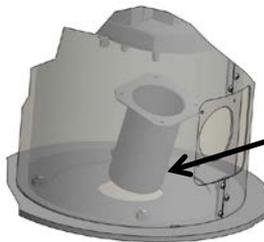
Dann muss der Faro hingelegt werden und der Deckel der Zuluftöffnung im Boden wird abgeschraubt ( 4 Zylinderkopfschrauben SW 4 mm). Hier wird jetzt der Zuluftstutzen durchgesteckt und montiert.
