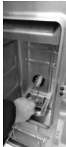
Fig. 40 - Reinigung mit Flaschenbürste
