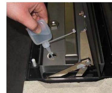
10. Verschließen Sie die Füllschraube fest, unter Zuhilfenahme des Schlüssels.
