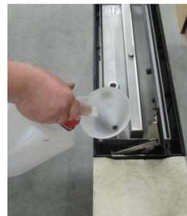
8. Das Füllstandsauge zeigt den maximal zulässigen Füllstand an.
