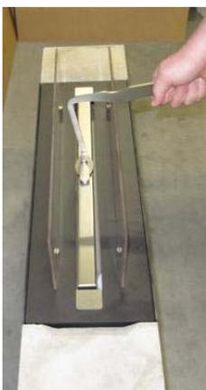
Im Falle einer vorzeitigen Außerbetriebnahme verschließen Sie den Brenner mittels des Abdeckbleches unter Zuhilfenahme des Griffstabs.
