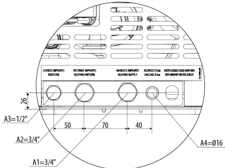
A1 = Wasservorlauf Heizung 3/4" M
