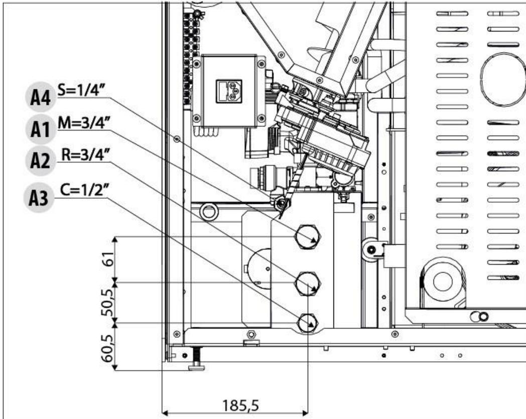
A1 = Wasservorlauf Heizung 3/4\"M
