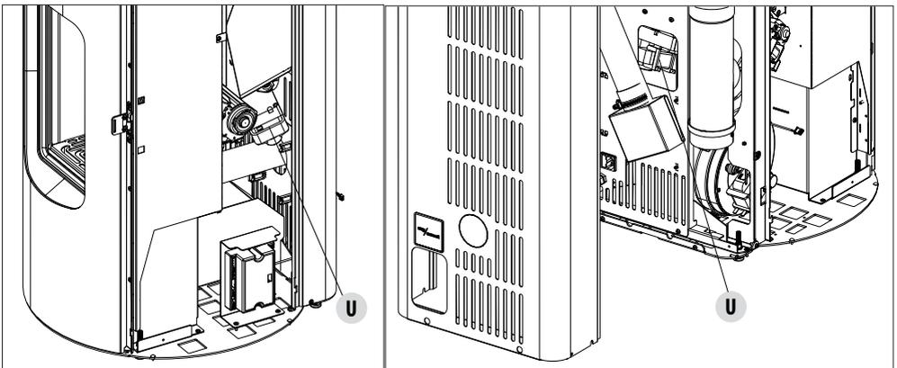
Um Zugang auf den Getriebemotor zu haben, muss die Seitenplatte entfernt werden.
