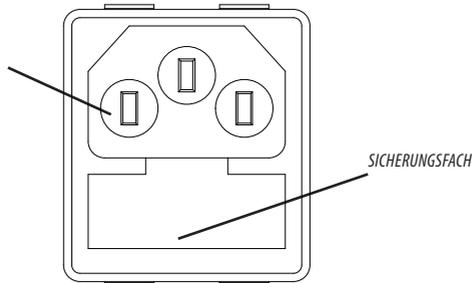
zwei Sicherungen (5x20 mm T träge/3,15 A 250 V), die im Fall einer Störung der Versorgung des Ofens eventuell ausgetauscht werden müssen (Bsp.: Das Display der Bedientafel leuchtet nicht) - diese Tätigkeiten dürfen ausschließlich von dazu befugten und qualifizierten Technikern durchgeführt werden.
