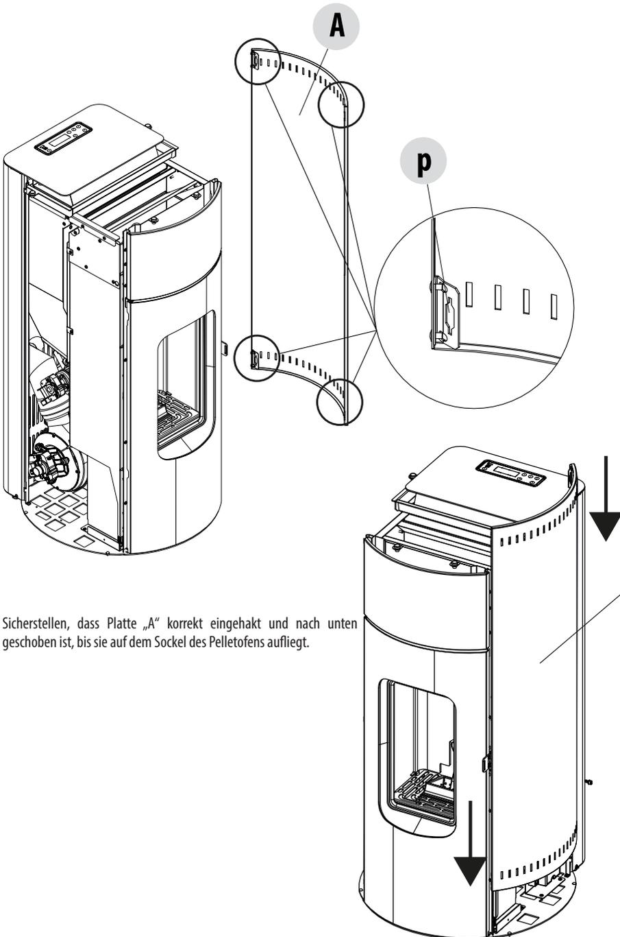
Sicherstellen, dass Platte „A“ korrekt eingehakt und nach unten geschoben ist, bis sie auf dem Sockel des Pelletofens aufliegt.
