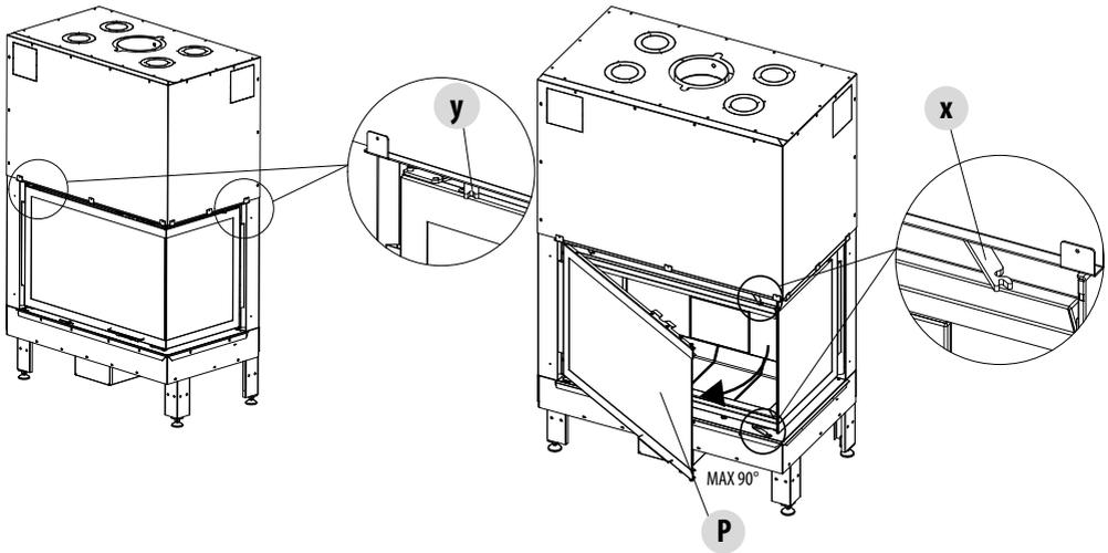
Die Tür muss während des Betriebs des Heizkamins in vollständig abgesenkter Stellung sein.
