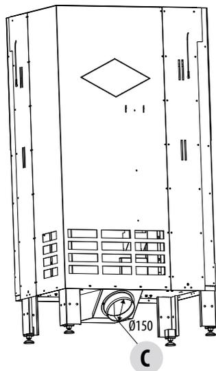
C = VERBRENNUNGSLUFT-ZULEITUNG Ø150
