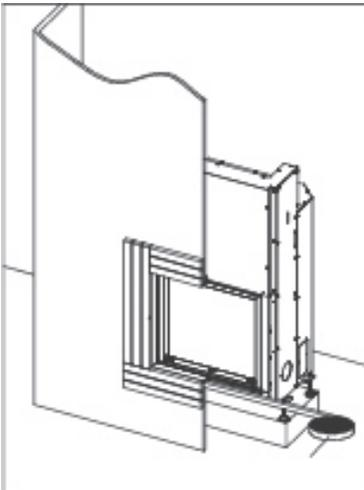
ISOLIERUNG DES HEIZKAMINS VON DEN WÄNDEN
