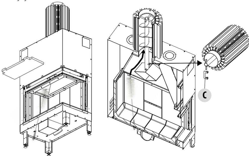
Um diesen Vorgang einfacher zu gestalten, ist das System mit einem Handgriff „C“ ausgestattet, um die Vorrichtung um  $360^\circ$  drehen und so komplett nach oben fahren zu können.
