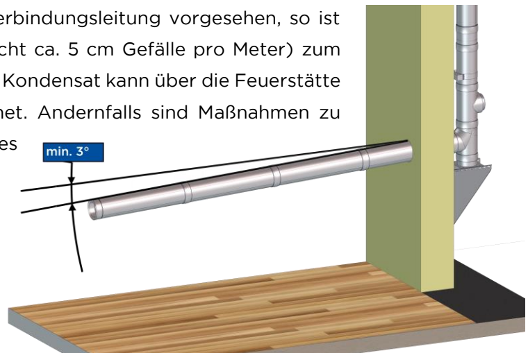
Bild 6-1: Notwendiges Gefälle (feuchte Betriebsweise)
