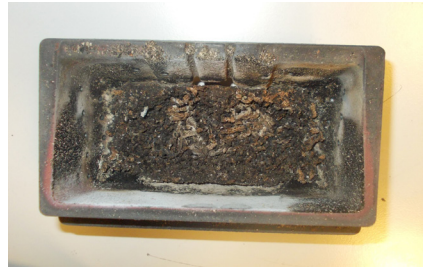
BEISPIEL VERSCHMUTZTE BRENNSCHALE
