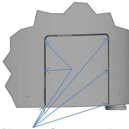
Diese Stege müssen durchgetrennt und das Blech entfernt werden, damit ein Zuluftkanal von hinten an den Zuluftstutzen montiert werden kann.
