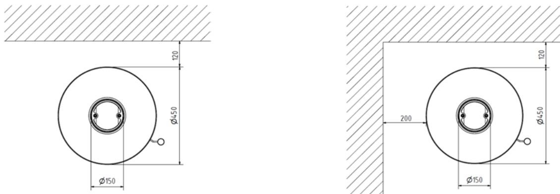
Der Sicherheitsabstand muss zu brennbaren Bauteilen und Möbeln nach hinten mindestens 12 cm und zu den Seiten mindestens 20 cm betragen. Im Strahlungsbereich der Glasscheibe dürfen im Abstand von 80 cm keine brennbaren Bauteile oder Möbel aufgestellt werden. Wenn der NANO mit einem Drehteller ausgestattet ist, darf der Ofen im heißen Zustand nicht in Richtung brennbarer Bauteile oder Möbel gedreht werden, wenn der Abstand zu diesen nicht mindestens 80 cm beträgt.
