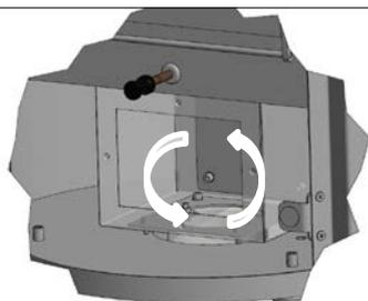
Das Rückwandblech kommt an den Boden und das Adapterblech mit Zuluftstutzen in die Rückwand.
