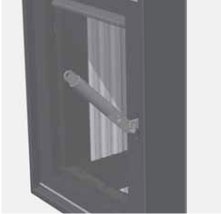
Abb. 3.3 Türverschluss und Bediengriff („kalte Hand“) bei linkem Türanschlag
