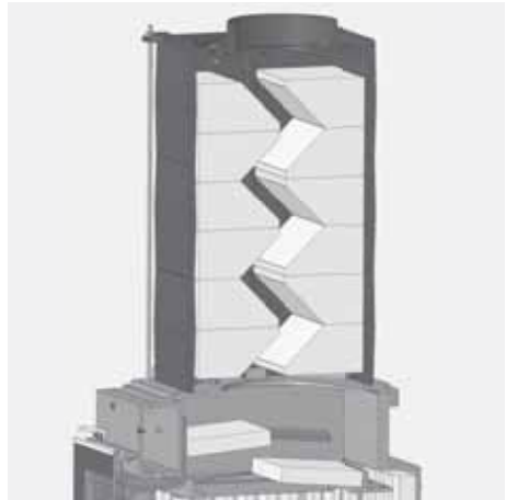
Abb. 3.28 Guss-Speicheraufsatz, Heizgasführung, Schnittdarstellung
