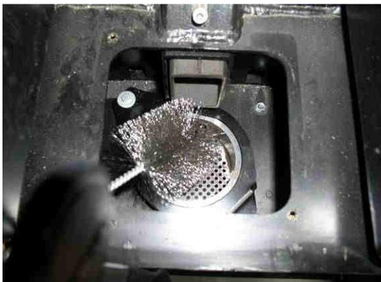
Abb. 122: Schwenkrost reinigen
