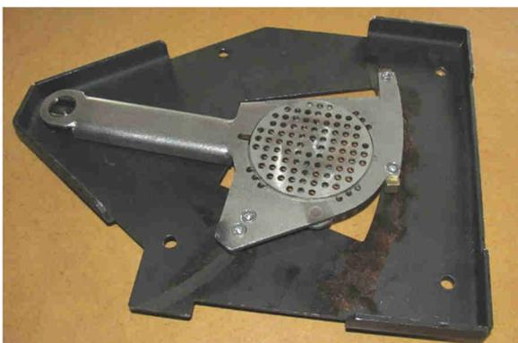
Abb. 129: Rostträgerplatte mit Schwenkrost
