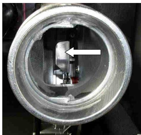
Abb. 144: Abluftstutzen mit Flügelrad
