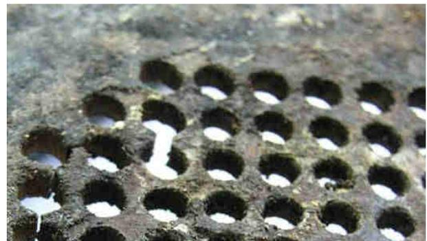
Abb. 126: Schwenkrost gerissen
