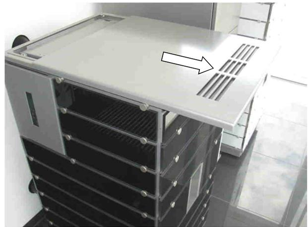
Abb. 86: Gerätedeckel BM01 „ivo.tec“ verschieben
