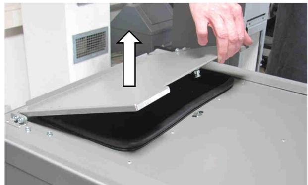
Abb. 87 Öffnen Pelletbehälter BM01-2 ivo.safe
