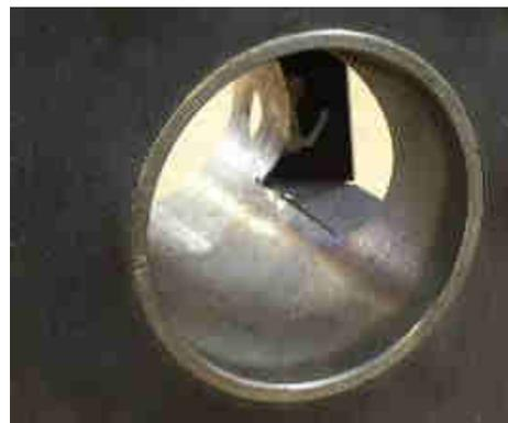
Abb. 117: Gereinigter Brennerkopf
