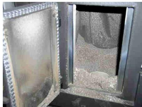
Abb. 95: Verschmutzter Feuerraum
