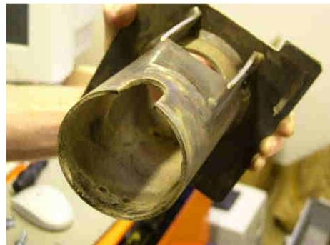
Abb. 116: Gereinigter Brennerkopf
