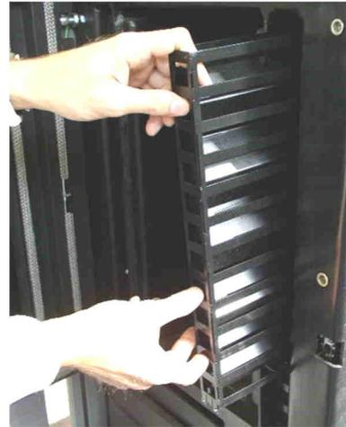
Abb. 136: Entnahme WT-Reinigung
