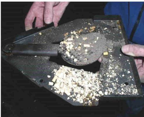
Abb. 128: Schwenkrost vom Träger entfernen
