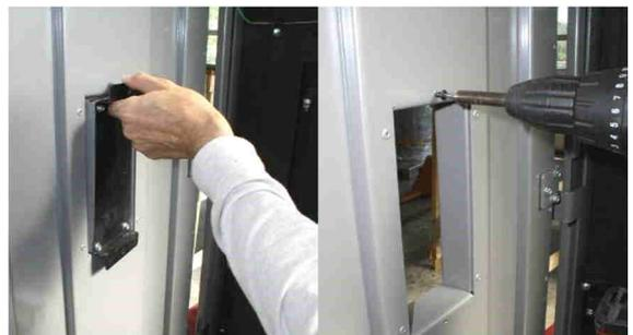
Abb. 25: Demontage / Montage Sichtblende
