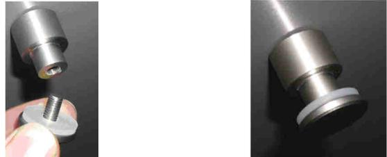
Abb. 29: Montage Klemmschrauben
