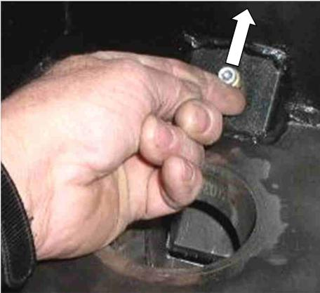
Abb. 118: Repetierhebel nach oben drücken!
