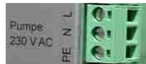
Abb. 75: Ausgang Pumpe
