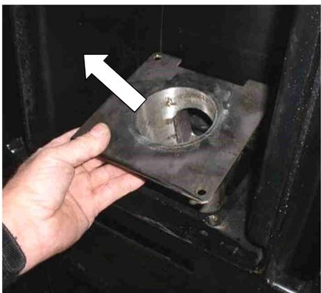
Abb. 114: Entnahme Brennerkopf
