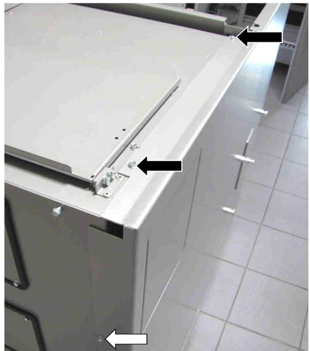
Abb. 16: Demontage Seitenverkleidung ivo.safe®
