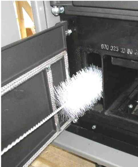
**Abb. 138: Reinigung Heizgaszüge unten**
