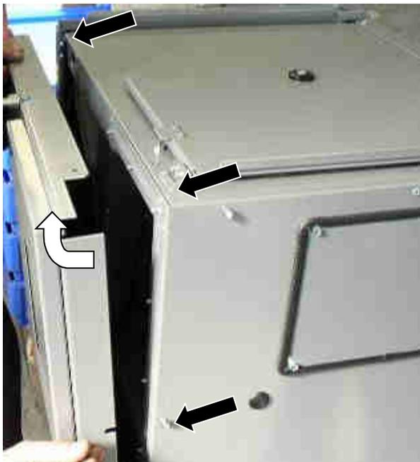
Abb. 13: Demontage Seitenverkleidung
