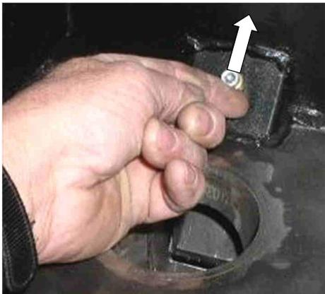
Abb. 113: Repetierhebel nach oben drücken!
