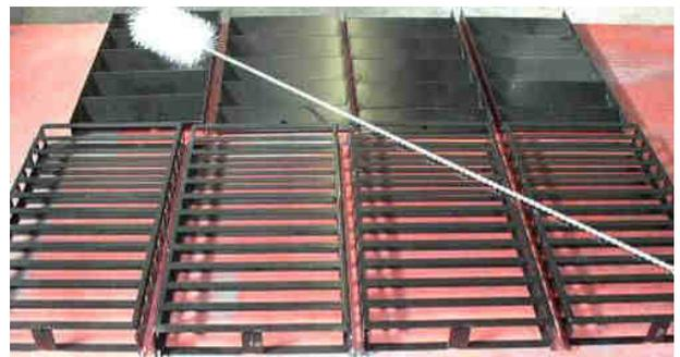
**Abb. 141: Turbulatoren und WT- Rechen**
