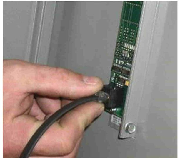
Abb. 15: Kabel Bedienboard
