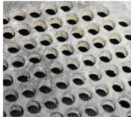
Abb. 124: Schwenkrost richtig gereinigt
