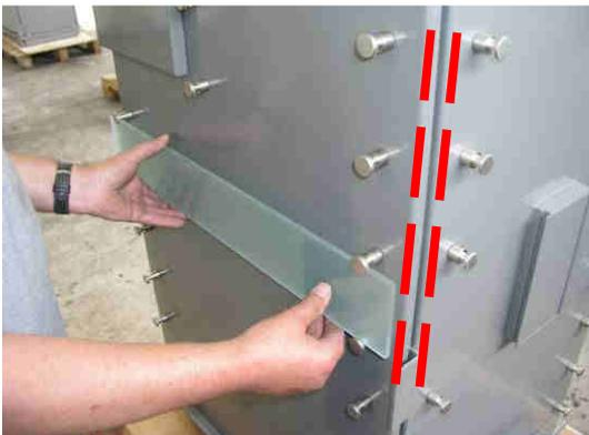
Abb. 33: Ausrichten Dekorglas
