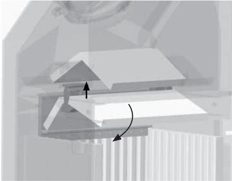
Abb. 3.14 VID A 55 W und 78 W: Heizgasumlenkungen entfernen.
