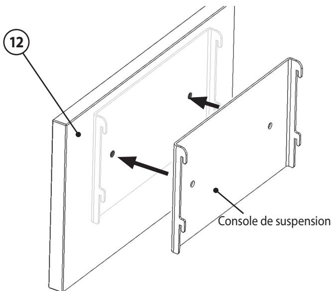
Vous trouverez la position exacte de la console de suspension sur le dos de la dalle de devant de l'appareil (12) en essayant différentes positions de la dalle de devant (12) munie de sa console au-dessus de la porte du foyer (3).
