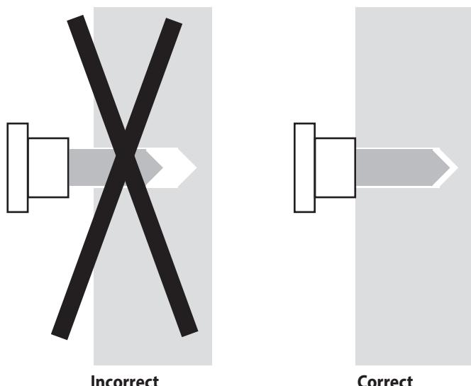
Si l'utilisation d'un tournevis ne suffit pas, veuillez terminer avec une pince serre-tube pour bien enfoncez la vis.
