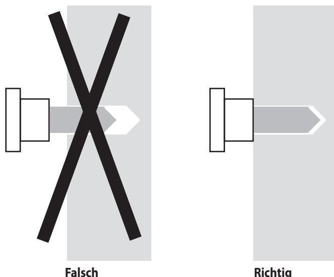
Sollte die Montagekraft eines Schraubendrehers nicht ausreichen, benutzen Sie bitte eine Wasserpumpenzange für die letzten Gewindégänge.
