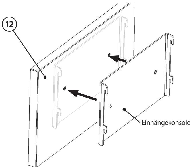
Die exakte Position der Einhängekonsole an der Rückseite des Frontsteines Grundgerät (12) muss durch probeweises Einhängen des Frontsteines Grundgerät (12) zusammen mit der montierten Einhängekonsole in den Gerätekörper über der Feuerraumtür (3) ermittelt werden.
