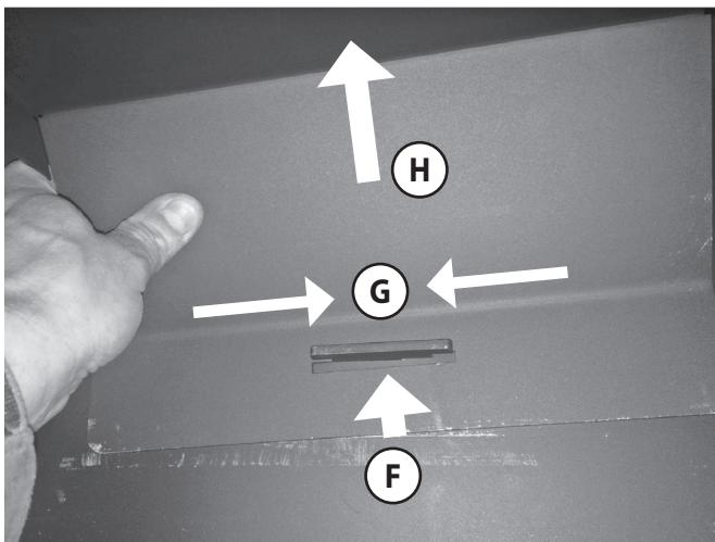
Die 4. Rauchgasumlenkung ist mit einer Bajonetthalterung an der Decke im Inneren des Gerätekörpers befestigt.
