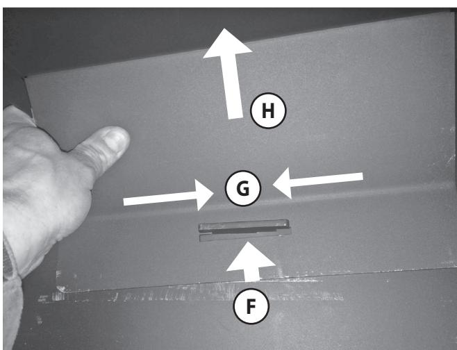
Le quatrième déflecteur est fixé sur le plafond de l'intérieur de l'appareil sur un support baïonnette.
