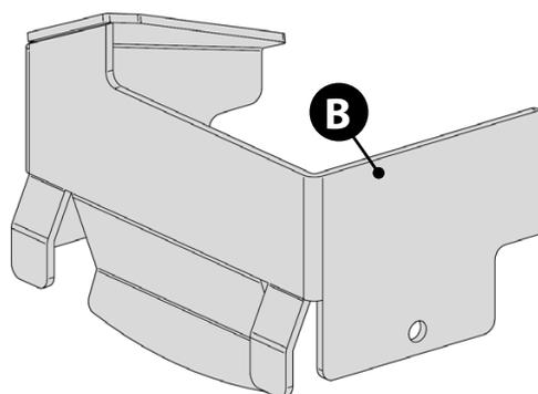
Für die Reinigung und Entfernung der Brennschale muss die Feuerschutzplatte (B) erhoben und entfernt werden.
