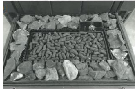
Abb. 2.22 Verteilung der Chips um das Brennerbett
