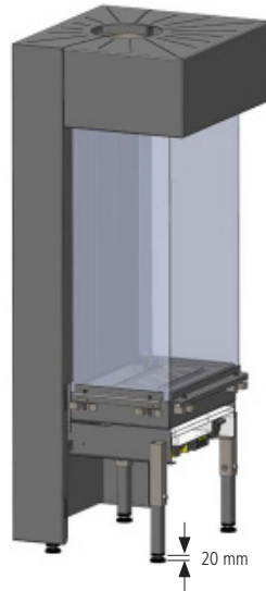
Abb. 2.3 Verwenden Sie die Schwenkbeine, um sicherzustellen, dass der Kamin eben ist.
