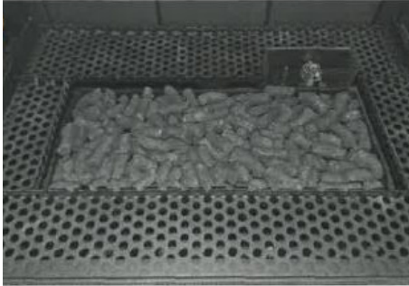
Abb. 2.21 Einlegen der Chips auf das Brennerbett.
