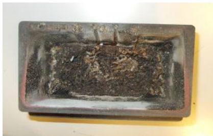
BEISPIEL VERSCHMUTZTE BRENNSCHALE
