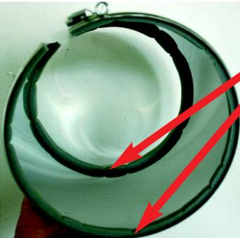
... danach ist das Klemmband zu montieren und durch die Verschlüsse zu sichern.
