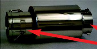
Das Außenrohr ist an beiden Enden kürzer als das Innenrohr
