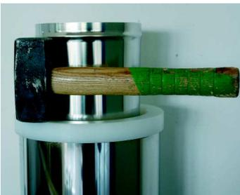
Anschließend ist das Außenrohr mit dem passenden Schlagring zu verdichten.
