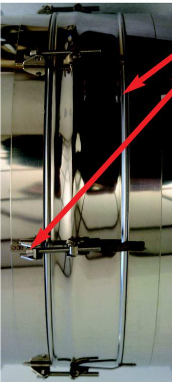
Ab  $\varnothing$  400 mm wird an beiden Rohrenden eine sogenannte Verstärkungssicke eingedreht.
